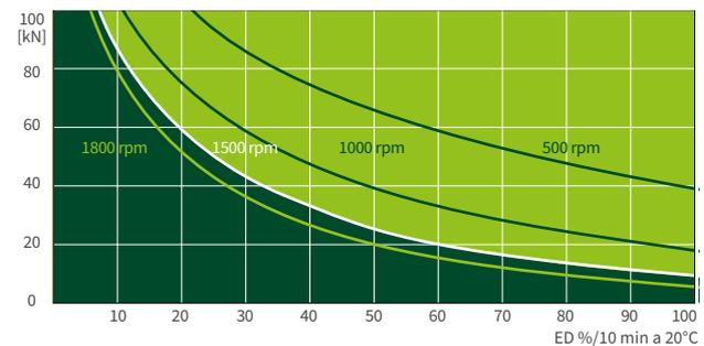
I diagrammi termici d'esercizio delle versioni S+R, sono riferiti a condizioni di lavoro standard (temperatura ambiente 20°C ecc.) e manutenzione corretta (lubrificazione ecc.). I diagrammi specifici si riferiscono all'afflettatura trapezoidale standard ZIMM Tr 55x9. Con viti a ricircolo di sfere KGT, i cicli di lavoro possono essere maggiori.
