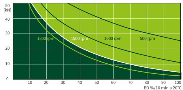
I diagrammi termici d'esercizio delle versioni S+R, sono riferiti a condizioni di lavoro standard (temperatura ambiente 20°C ecc.) e manutenzione corretta (lubrificazione ecc.). I diagrammi specifici si riferiscono alla filettatura trapezoidale standard ZIMM Tr 40x7. Con viti a ricircolo di sfere KGT, i cicli di lavoro possono essere maggiori
