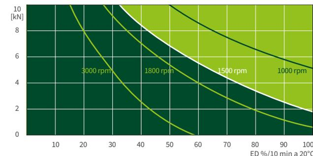
I diagrammi termici d'esercizio delle versioni S+R, sono riferiti a condizioni di lavoro standard (temperatura ambiente 20°C ecc.) e manutenzione corretta (lubrificazione ecc.). I diagrammi specifici si riferiscono alla filettatura trapezoidale standard ZIMM Tr 20x4. Con vitia ricircolo di sfere KGT, i cicli di lavoro possono essere maggiori.
