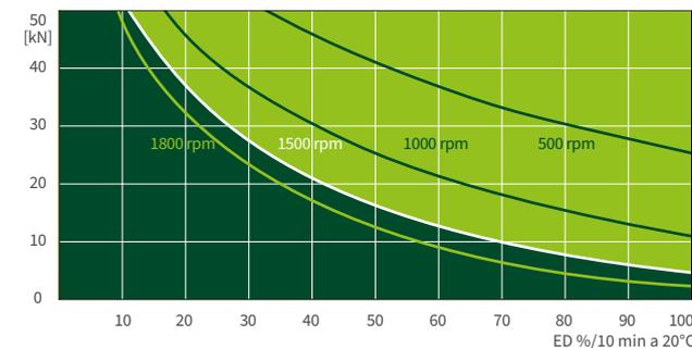
I diagrammi termici d'esercizio delle versioni S+R, sono riferiti a condizioni di lavoro standard (temperatura ambiente 20°C ecc.) e manutenzione corretta (lubrificazione ecc.). I diagrammi specifici si riferiscono alla filettatura trapezoidale standard ZIMM Tr 40x7. Con viti a ricircolo di sfere KGT, i cicli di lavoro possono essere maggiori. Per applicazioni con duty cycle maggiore e velocità più elevate, consultate le pagine 70 e 71, relative ai martinetti ad alte prestazioni ZE H.
