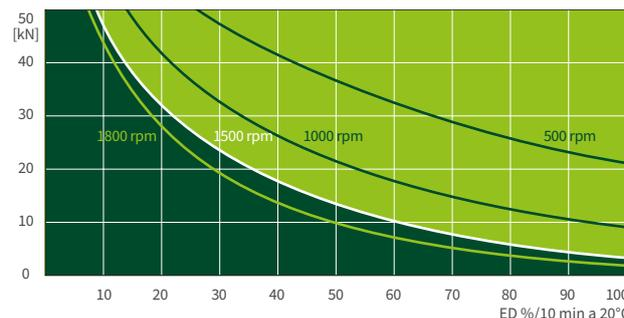
I diagrammi termici d'esercizio delle versioni S+R, sono riferiti a condizioni di lavoro standard (temperatura ambiente 20°C ecc.) e manutenzione corretta (lubrificazione ecc.). I diagrammi specifici si riferiscono alla filettatura trapezoidale standard ZIMM Tr 50x8. Con vitia ricircolo di sfere KGT, i cicli di lavoro possono essere maggiori. Per applicazioni con duty cycle maggiore e velocità più elevate, consultate le pagine 70 e 71, relative ai martinetti ad alte prestazioni ZE H.
